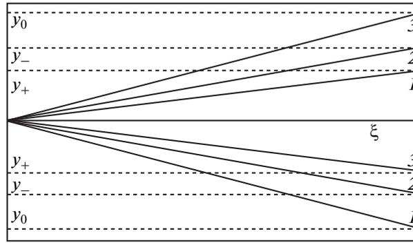
**Рис. 1.** Волновые фронты первой моды от движущегося осциллирующего источника возмущений: линия 1 – волновой фронт основного поля  $U_1^0$ , линия 2, 3 – волновые фронты дополнительных полей  $U_1^+$ ,  $U_1^-$  соответственно.
