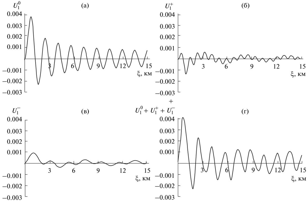
**Рис. 2.** Первая мода дальнего поля внутренних гравитационных волн от движущегося осциллирующего источника возмущений: 1 – функция  $U_1^0$ , 2 – функция  $U_1^+$ , 3 – функция  $U_1^-$ , 4 – сумма  $U_1^0 + U_1^+ + U_1^-$ .
